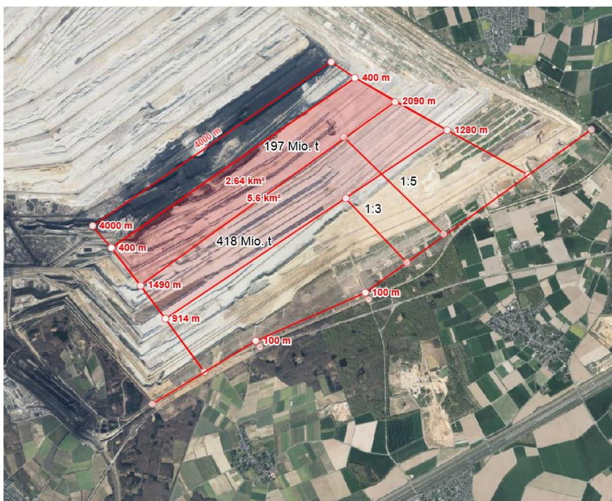
**Abbildung 4: Tagebau Hambach, Gewinnungsböschung 1:3 und 1:5, Tagebaukante Stand 09/2019**
