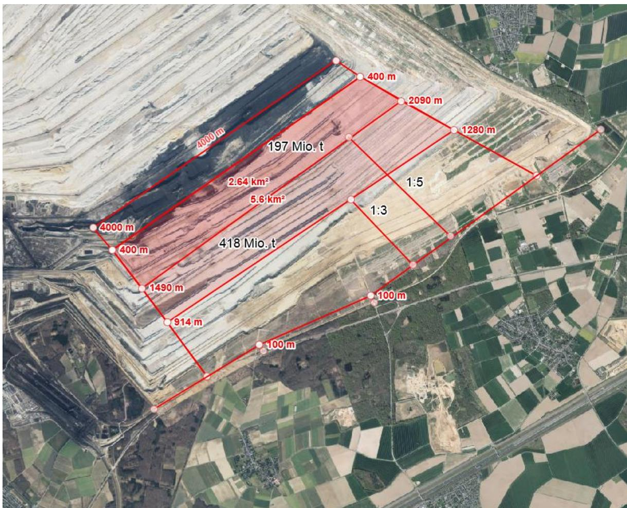
**Abbildung 9: Tagebau Hambach, Gewinnungsböschung 1:3 und 1:5, Tagebaukante Stand 09/2019**
